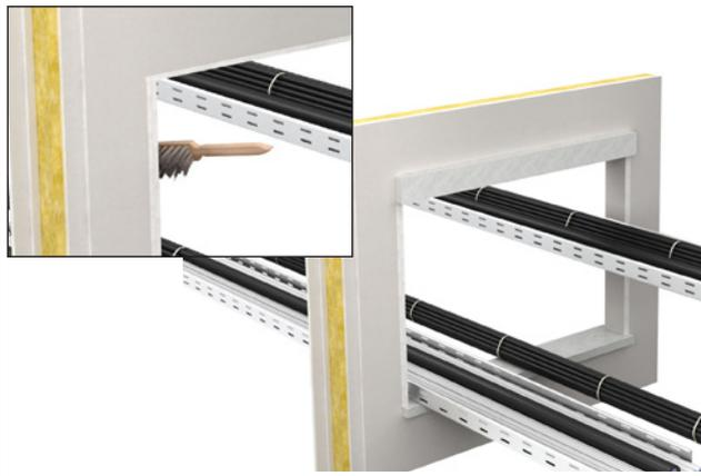
2. Kabel im Schottbereich (Länge  $\geq 160$  mm) mit SIBRALIT DX beschichten. Alternativ NBR-plus anordnen.
